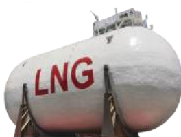
LNG FUEL TANK
