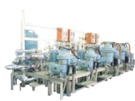
H.F.O & L.O Purifier Unit
